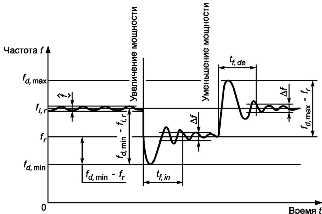
Рисунок 4 — Динамический режим частоты
