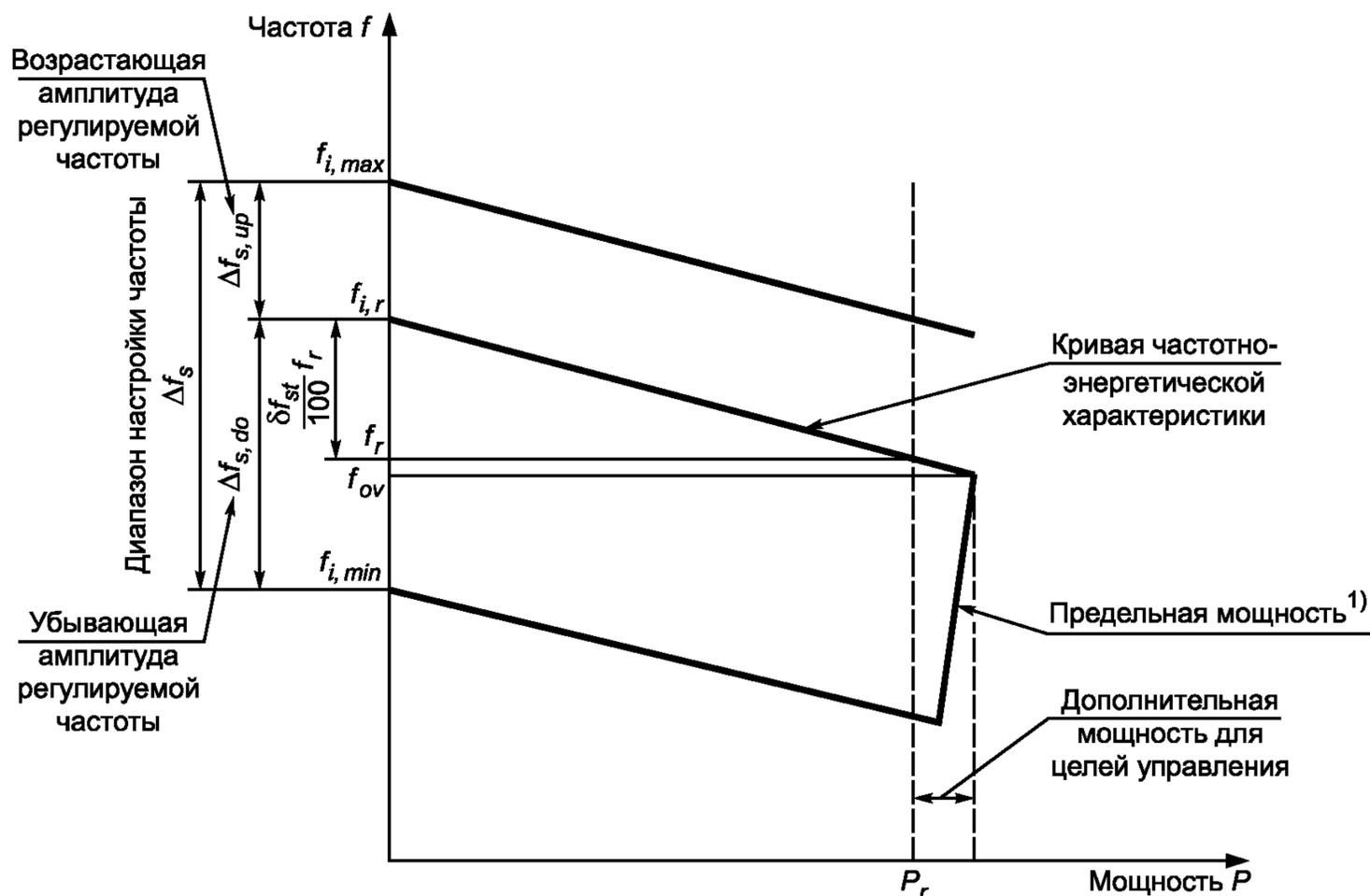
1) Предельное значение мощности электроагрегата зависит от предельного значения мощности двигателя внутреннего сгорания.
