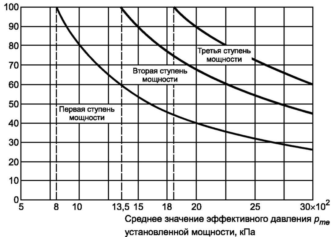
Рисунок 8 — Ориентировочные значения внезапного максимального повышения мощности как функции тормозного эффективного среднего значения давления  $p_{me}$  при объявленной мощности (четырёхтактные двигатели)
