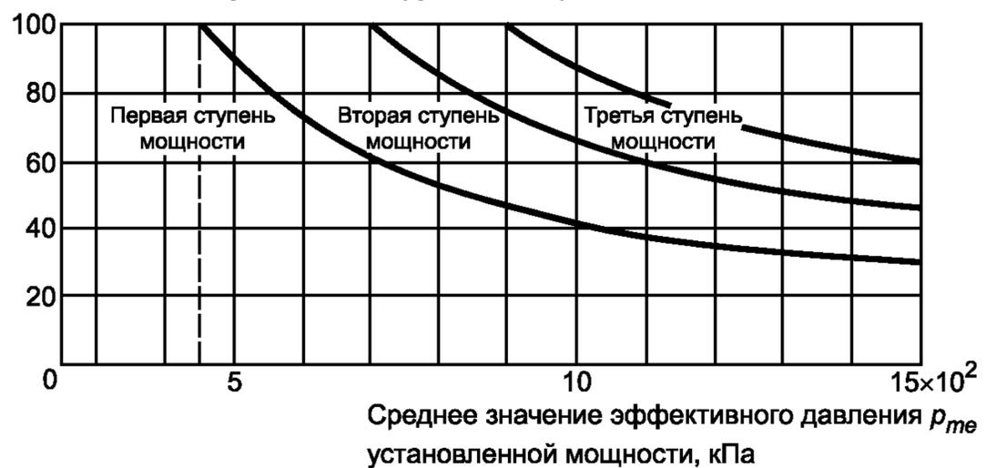
Рисунок 9 — Ориентировочные значения внезапных максимальных повышений мощности как функции тормозного эффективного среднего значения давления  $p_{me}$  при объявленной мощности (двухтактные высокоскоростные двигатели)
